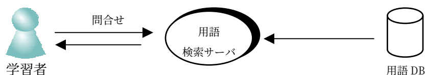
図 4.5: 用語検索エンジンシステムのデータの流れ
