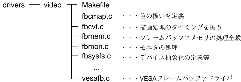
図 5.10: フレームバッファカーネルモジュールの構成
