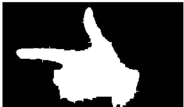
図 3.5 肌色最大領域を残した画像 (2 段階目ノイズ除去)
