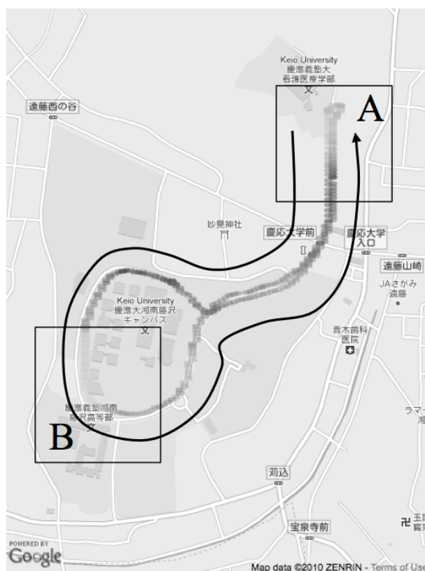
図 3.9: シャトルバスで測定された RSSI の変動とシャトルバスの経路
