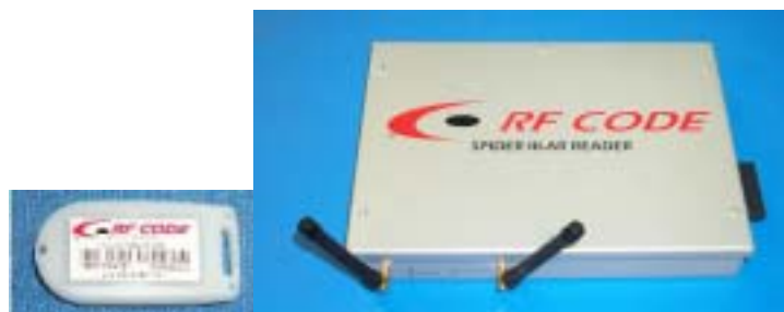
図 3.1: RF Code 社のスパイダー・システム RFID タグ(左)と RFID リーダー(右)
