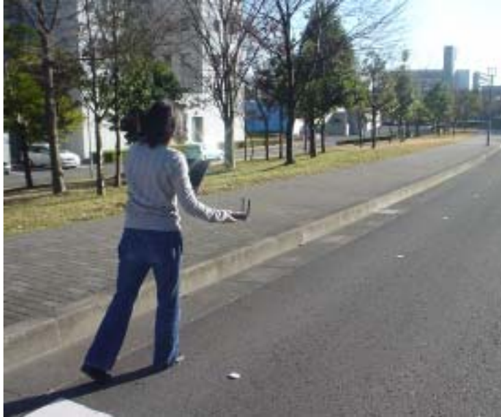
図 4.1： 実験風景 (RFID タグを 2m 間隔で配置し，時速 4km で移動した時の様子)
