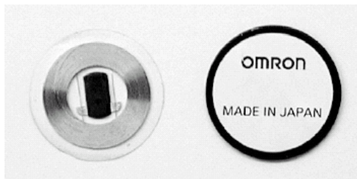
図2.7: 実験で使用された円盤型RFIDタグ(右)とその内部(左)
