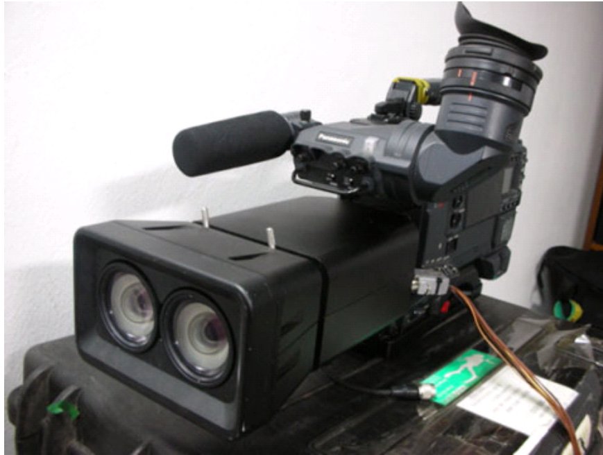
図 2.10 可変フレームレート（韓国 Wasol 社製 3 次元アダプタ）
