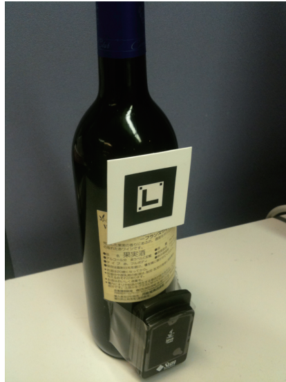
図 3.6 物体にビジュアルマーカとセンサが貼り付けられている様子
