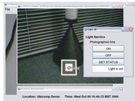
図 2.3 u-Photo によるライトの操作
