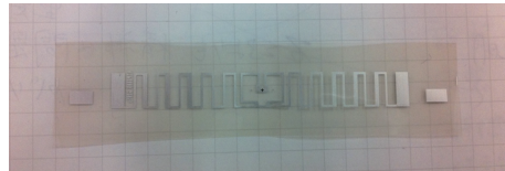
図 7.2 使用した Gen2 RF タグ
